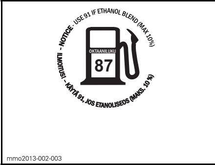
POLTTOAINESÄILIÖN KORKISSA - 550F- JA 600 ACE -MOOTTOREISSA (MAISSA, JOISSA OKTAANILUOKITUS ON AKI (RON+MON)/2)
