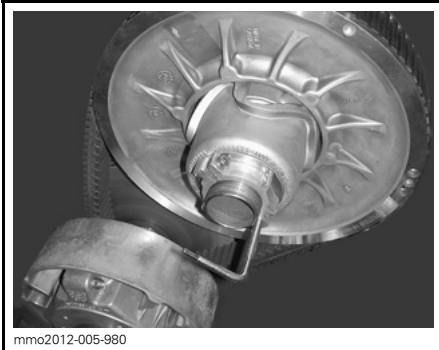
SCHEIBEN-EXPANDER AN NABE DER EINSTELLVORRICHTUNG MONTIERT
