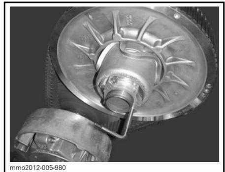
**SCHLEIBEN-EXPANDER AN NABE DER EINSTELLVORRICHTUNG MONTIERT**
