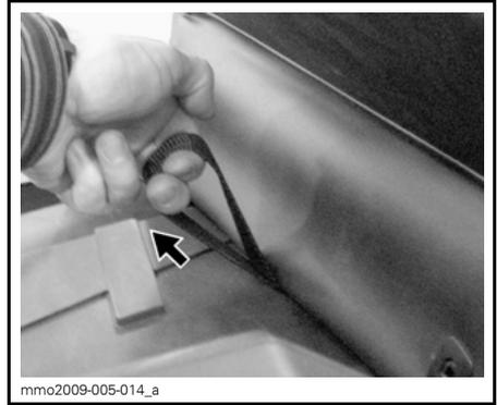
3. Heben Sie das hintere Ende des Sitzes an und ziehen Sie ihn vorsichtig gerade so weit nach hinten, dass der Zubehöranschluss freiliegt.
