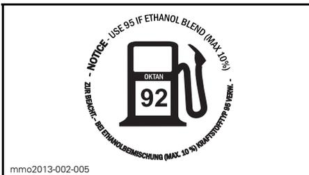
AUF DEM KRAFTSTOFFTANKDECKEL - BEI MOTOREN DES TYPUS 1200 4-TEC UND ACE - IN LÄNDERN, IN DENEN RON-OKTANZAHLANGABEN VERWENDET WERDEN
