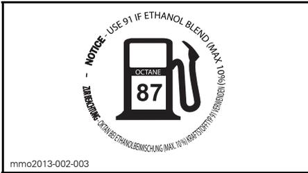
AUF DEM KRAFTSTOFFTANKDECKEL - BEI MOTOREN DES TYPUS 1200 4-TEC UND ACE - IN LÄNDERN, IN DENEN PUMP POSTED AKI (RON+MON)/2-OKTANZAHLANGABEN VERWENDET WERDEN
