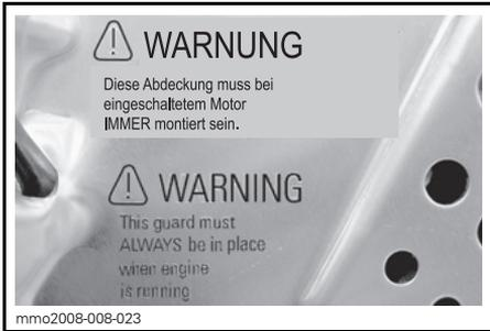
**AUFKLEBER 14 - AUF BREMSSCHEIBENSCHUTZVORRICHTUNG (AUF NACKTEM METALLTUNNEL)**
