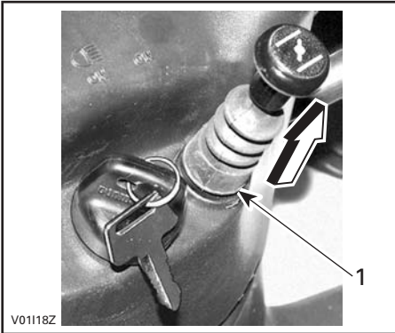
1. Choke in vollständig geöffneter Position
