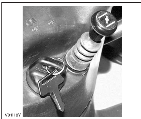
CHOKE IN VOLLSTÄNDIG GEÖFFNETER POSITION (FULL)
