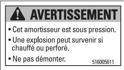
ÉTIQUETTE 14 - SUR LES AMORTISSEURS À GAZ
