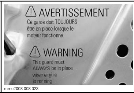
ÉTIQUETTE 13 - SUR LE PROTECTEUR DE DISQUE DE FREIN (TUNNEL EN MÉTAL NU)
