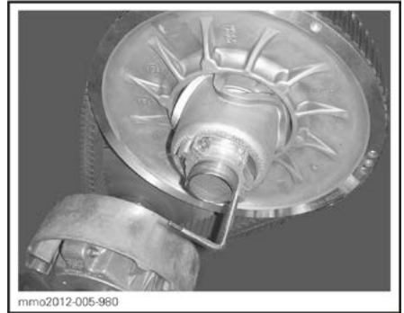
ТИПОВОЙ ВАРИАНТ – ПРИСПОСОБЛЕНИЕ ДЛЯ РАЗВЕДЕНИЯ ВЕДОМОГО ШКИВА УСТАНОВЛЕННО В РЕГУЛИРОВОЧНУЮ МУФТУ
