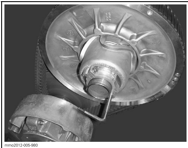
TIPICO - DISPOSITIVO DI ESPANSIONE DELLA PULEGGIA INSTALLATO SUL MOZZO DEL REGISTRO.
