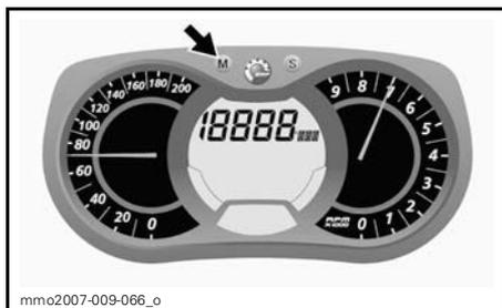
Pour remettre à zéro, appuyer sur le bouton de mode (M) pour sélectionner le mode.
