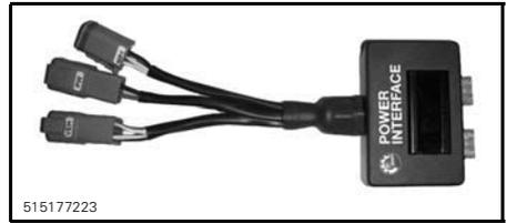
4. Brancher l'interface d'alimentation à une batterie de 12 V à l'aide du CÂBLE D'ALIMENTATION DE BATTERIE 12 V (N/P 529 035 997).
