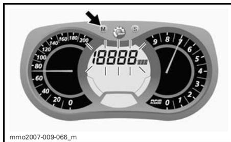
Alors que l'affichage clignote, appuyer sur le bouton de réglage (S) pour sélectionner le mode de vitesse moyenne (AVR\_SPD).
