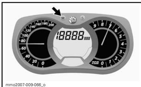
Pour remettre à zéro la température maximale enregistrée, appuyer sur le bouton de MODE (M) pour sélectionner le mode.
