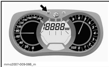
Alors que l'affichage clignote, appuyer sur le bouton de réglage (S) et le tenir dans les 5 prochaines secondes pour remettre à zéro.
