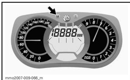
Alors que l'affichage clignote, appuyer sur le bouton de réglage (S) pour sélectionner le mode indicateur de vitesse.
