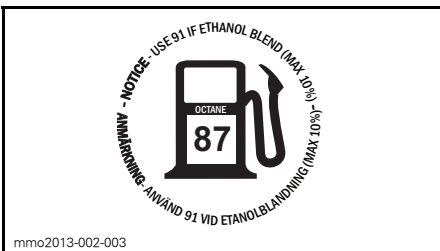
FINNS PÅ TANKLOCKET - PÅ 1200 4-TEC- OCH 900 ACE-MOTORER (I LÄNDER SOM ANVÄNDER AKI (RON+MON)/2 PUMPOKTANTAL)
