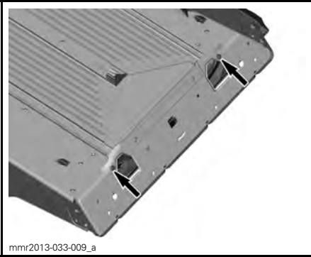
mmr2013-033-009_a FESTEBOLTENES PLASSERING - SETT FRA UNDERSIDEN
