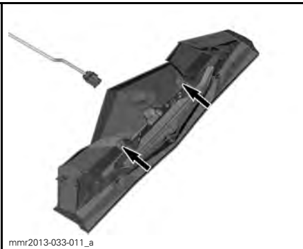
mmr2013-033-011_a FJERNE SKRUENE SOM HOLDER BAKLYKTEN MOT BAKLYKTSTØTTEN
