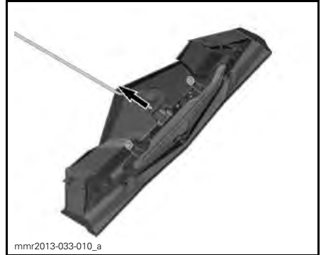
DÉBRANCHEMENT DU CONNECTEUR DU FEU ARRIÈRE
