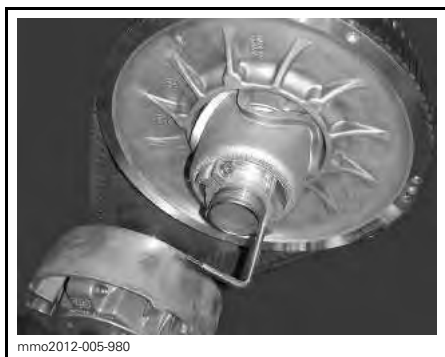
MANDRIN DE POULIE MENÉE INSTALLÉ SUR L'ANNEAU DE RÉGLAGE
