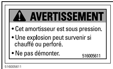
ÉTIQUETTE 17 - SUR LES AMORTISSEURS À GAZ
