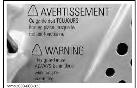
ÉTIQUETTE 16 - SUR LE PROTECTEUR DE DISQUE DE FREIN (TUNNEL EN MÉTAL NU)
