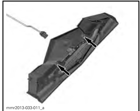
BOULONS DE RETENUE QUI RETIENNENT LE FEU ARRIÈRE À LEUR SUPPORT
