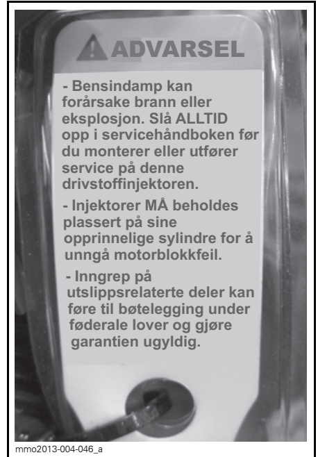
DEKAL 16 – PÅ DRIVSTOFFINJEKTORER – E-TEC-MODELLER
