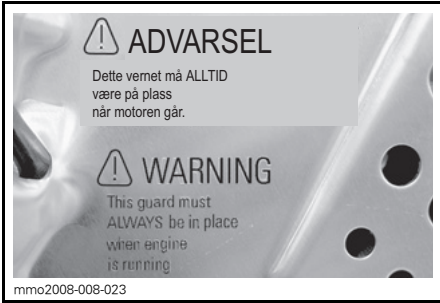
DEKAL 14 – PÅ BREMSEKIVEVERN (BART METALL PÅ TUNNEL)
