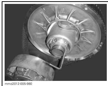
MANDRIN DE POULIE MENÉE INSTALLÉ SUR LE DISPOSITIF DE RÉGLAGE
