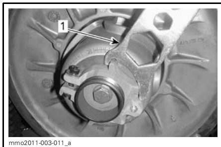
1. Outil de réglage de la suspension
