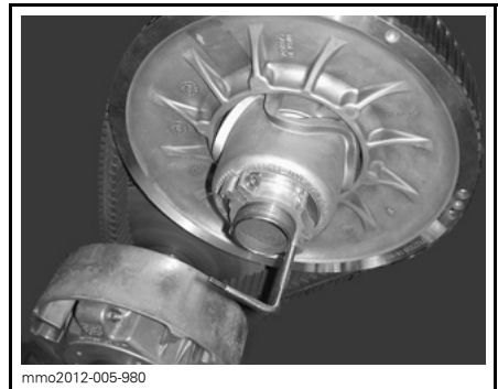
VARIAATTORIN AVAUSTYÖKALU ASENNETTUNA SÄÄTIMEN NAPAAN
