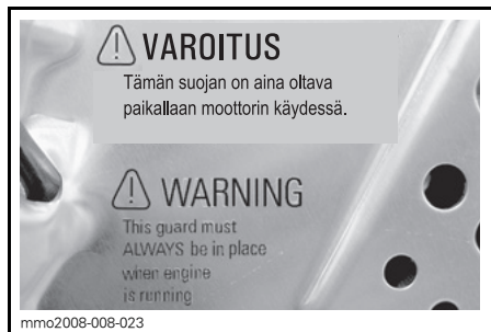
KILPI 14 - JARRULEVYN SUOJASSA (PELKKÄ METALLITUNNELI)
