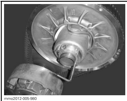
SCHEIBEN-EXPANDER AN NABE DER EINSTELLVORRICHTUNG MONTIERT
