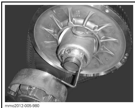
DISPOSITIVO DI ESPANSIONE DELLA PULEGGIA INSTALLATO SUL MOZZO DEL REGISTRO.
