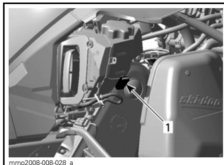
HEFÐBUNDIÐ - HÆGRI HLIÐ VÉLARHÓLFS 1. 5 A öryggi ræsingar/snarvindu
