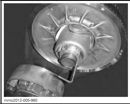
VARIAATTORIN AVAUSTYÖKALU ASENETTUNA SÄÄTIMEN NAPAAN
