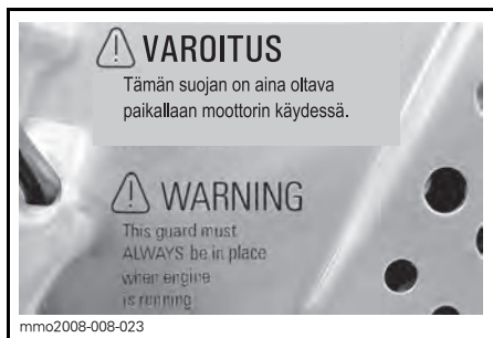
KILPI 13 - JARRULEVYN SUOJASSA (PELKKÄ METALLITUNNELI)
