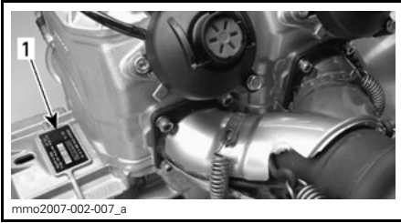
TYPISCH - 600 HO E-TEC-MOTOR 1. Motor-Identifizierungsnummer
