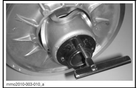
VARIATORNS UTVIDGARE INSTALLERAD PÅ JUSTERINGSNAV I PLAST
