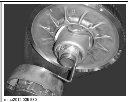
VARIATORNS UTVIDGARE INSTALLERAD PÅ JUSTERINGSNAV I ALUMINIUM
