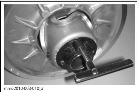
VARIAATTORIN AVAUSTYÖKALU MUOVISEN SÄÄTIMEN NAVASSA
