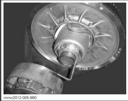
VARIAATTORIN AVAUSTYÖKALU ALUMIINISEN SÄÄTIMEN NAVASSA
