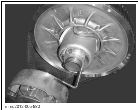
SCHEIBEN-EXPANDER AN NABE DER EINSTELLVORRICHTUNG MONTIERT
