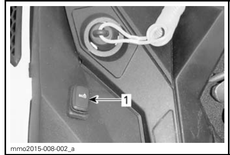
TYPISCH - LINKE SEITE DES KRAFTSTOFFTANKS 1. Modus-Schalter
