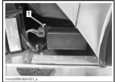
1. Boîte à fusibles
