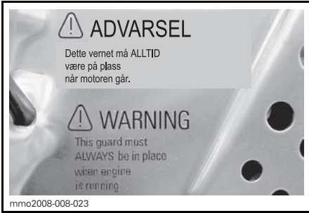
DEKAL 14 – PÅ BREMSEKIVEVERN (BART METALL PÅ TUNNEL)
