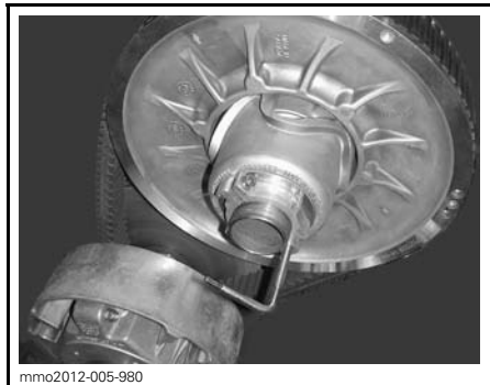
mmo2012-005-980 VARIAATTORIN AVAUSTYÖKALU ASENETTUNA SÄÄTIMEN NAPAAN
