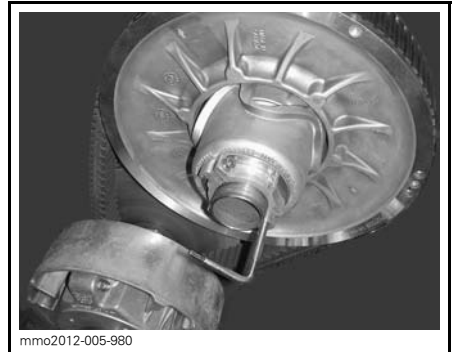
VARIAATTORIN AVAUSTYÖKALU ASENNETTUNA SÄÄTIMEN NAPAAN
