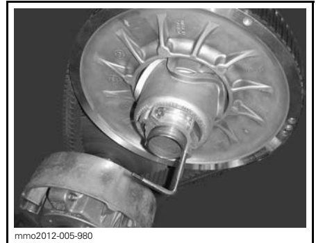
mimo2012-005-980 VARIATORNS UTVIDGARE INSTALLERAD PÅ JUSTERINGSNAVET
