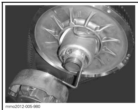
VARIATORNS UTVIDGARE INSTALLERAD PÅ JUSTERINGSNAVET
