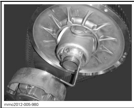
VARIATORNS UTVIDGARE INSTALLERAD PÅ JUSTERINGSNAVET
