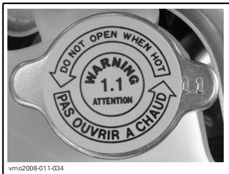
**BOUCHON DU RÉSERVOIR DE LIQUIDE DE REFROIDISSEMENT**
