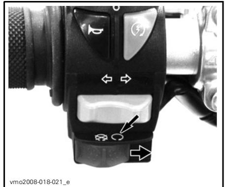
Mettre la transmission au point mort ou appuyer sur le levier d'embrayage et le maintenir ainsi.
