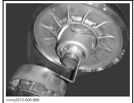
VARIATORNS UTVIDGARE INSTALLERAD PÅ JUSTERINGSNAVET
