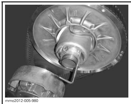
FORLENGER FOR DRIVREIM MONTERT PÅ JUSTERINGSNAV
