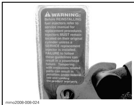
ÉTIQUETTE 4 - SUR LES INJECTEURS - MODÈLES E-TEC
