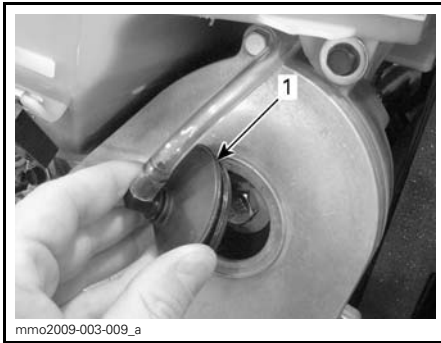
1. Bouchon de remplissage
