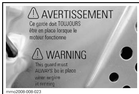
mmo2008-008-023 ÉTIQUETTE 16 - SUR LE PROTECTEUR DE DISQUE DE FREIN (TUNNEL EN MÉTAL NU)
