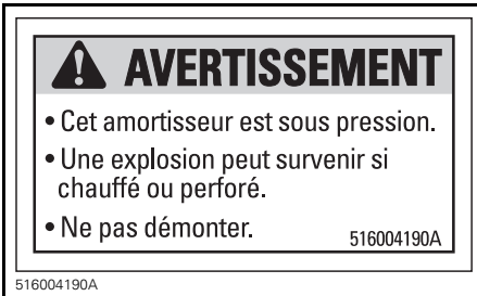
ÉTIQUETTE 15 - SUR LES AMORTISSEURS À GAZ
