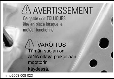
KILPI 14 - JARRULEVYN SUOJASSA (PELKKÄ METALLITUNNELI)
