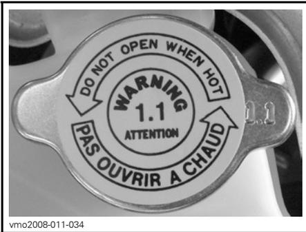
**TAMPÃO DO DEPÓSITO DO LÍQUIDO DE ARREFECIMENTO DO MOTOR**
