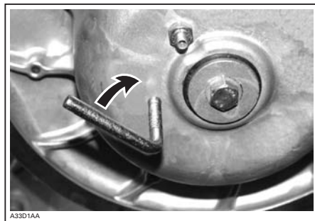
VERKTØY FOR Å MONTERE / TA AV DRIVREIMEN
