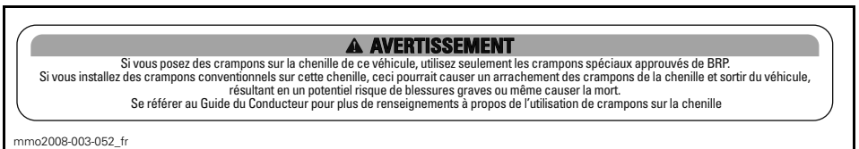
ÉTIQUETTE 12 - MODÈLES AVEC CHENILLE APPROUVÉE POUR L'UTILISATION DE CRAMPONS
