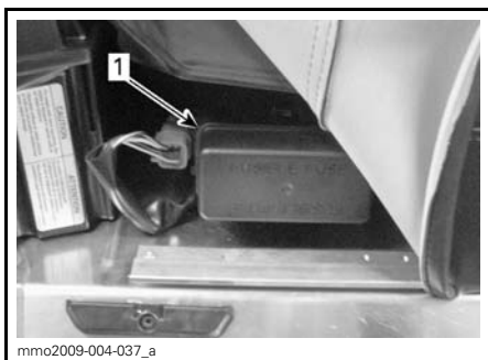
1. Boîte à fusibles
