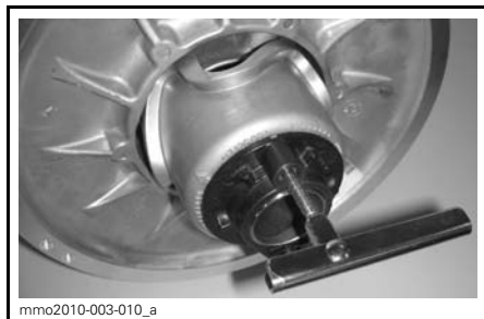
VARIAATTORIN AVAUSTYÖKALU MUOVISEN SÄÄTIMEN NAVASSA
