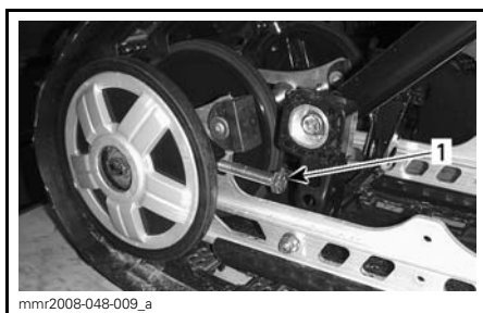
1. Vis de réglage droite
