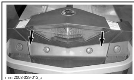
TYPIQUE - TIRER LA LENTILLE AVEC PRÉCAUTION AUX DEUX EXTRÉMITÉS
