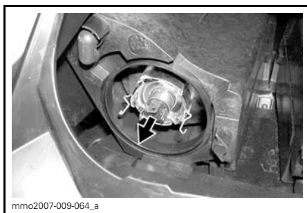
TIRER SUR L'AMPOULE ET LA REMPLACER
