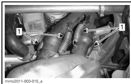
1. Fästfjädrar mellan avgasrör och ljuddämpare
