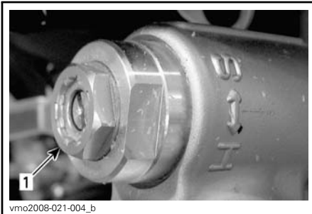
1. Dispositif de réglage de compression (vitesse élevée) (clé de 17 mm)
