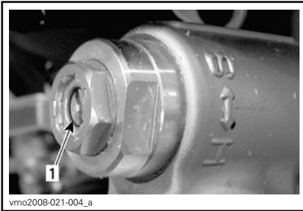
1. Dispositif de réglage de la compression (tournevis à lame plate)
