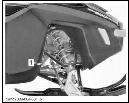
ESIMERKKI - SÄÄTÖNOKKATYYPPISEN ESIJÄNNITYS 1. Säätönokka
