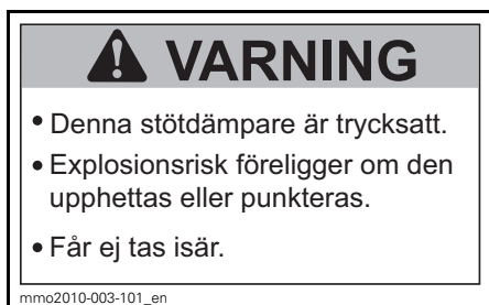
DEKAL 11 – PÅ GASFYLLDA STÖTDÄMPARE
