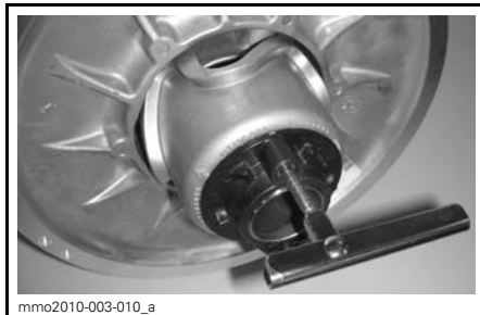
JUSTERING AV REIMSKIVE - RINGJUSTERING
