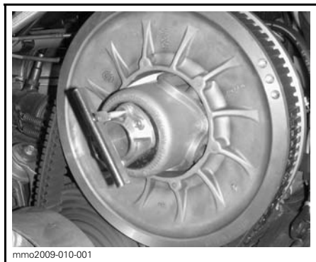
JUSTERING AV REIMSKIVE - SKRUEJUSTERING
