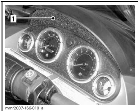
1. Luftfiltret monterat i inloppskanalen.
