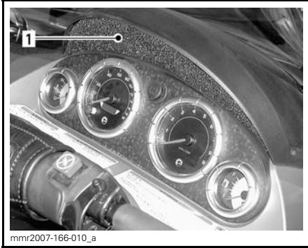
1. Filtro dell'aria installato nel condotto di aerazione
