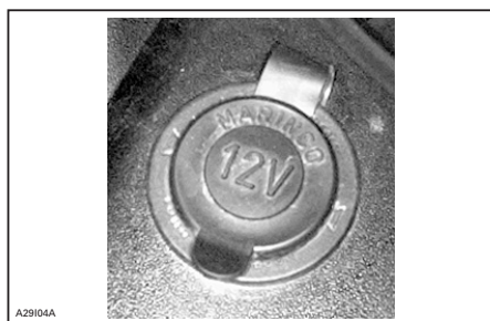
TIPICA — PRESA DI ALIMENTAZIONE ELETTRICA
