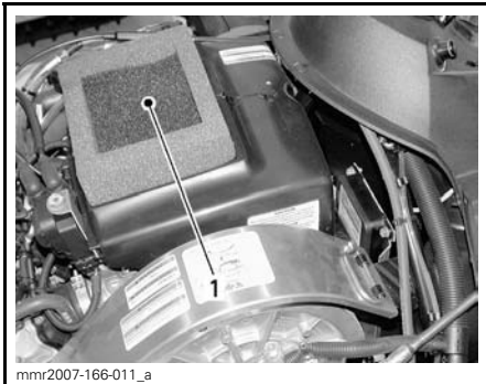
1. Filtro dell'aria montato sulla parte superiore del silenziatore della presa d'aria
