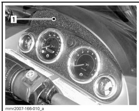
1. Filtre placé dans l'arrivée d'air
