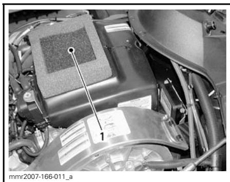
1. Filtre à air installé sur le silencieux
